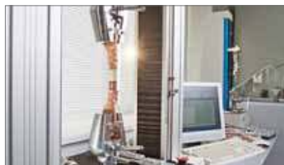
Испытания наконечников на разрывное усилие
