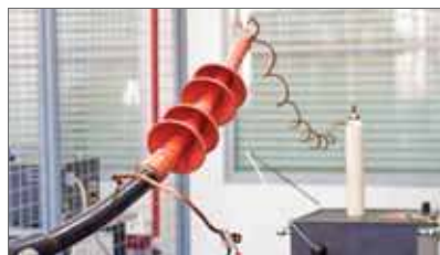
Высоковольтные испытания кабельных муфт
